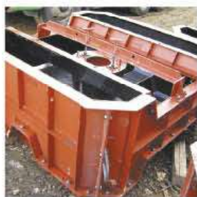
①型枠組立
