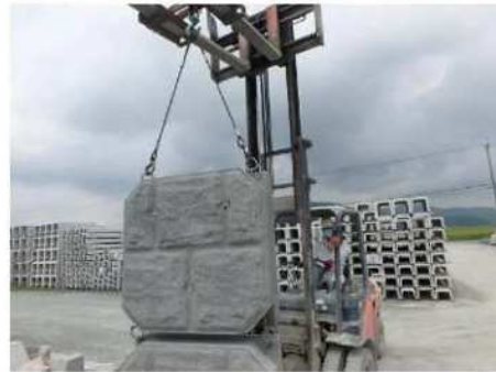
写真-1 連結金具によりロックル385型2個を垂直に吊り上げ、河川洗堀（実験における想定断面）と同じ状況を作って強度を確認
