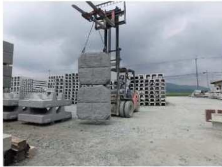
写真-1 連結金具によりロックル385型2個を垂直に吊り上げ、河川洗堀（実験における想定断面）と同じ状況を作って強度を確認
