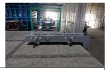
取り付け時は、製品中央寄りの吊具固定治具から差し込む
